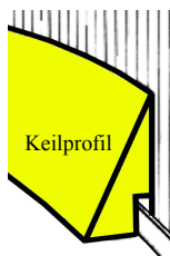
Beckenwand mit Schiene unten
