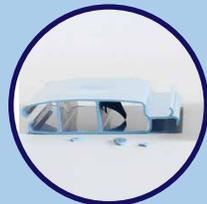
Schäden bei Hagel und Frost sind wegen den Hohlräumen schnell möglich
