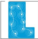
Automatisches Führungssystem AquaPilot zur Abdeckung des gesamten Beckens. Durch die spiralförmige Fortbewegung bleibt der Roboter nirgends stecken.
